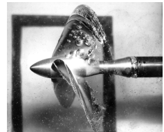
образовање мехурова паре на лопатицама пропелера
