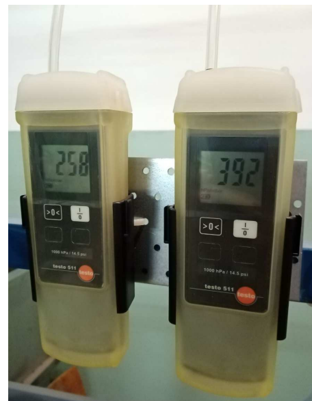
Слика 1.18. Дигитални манометри Testo 511 коришћени за мерење натпритисака испред и иза вентила.
