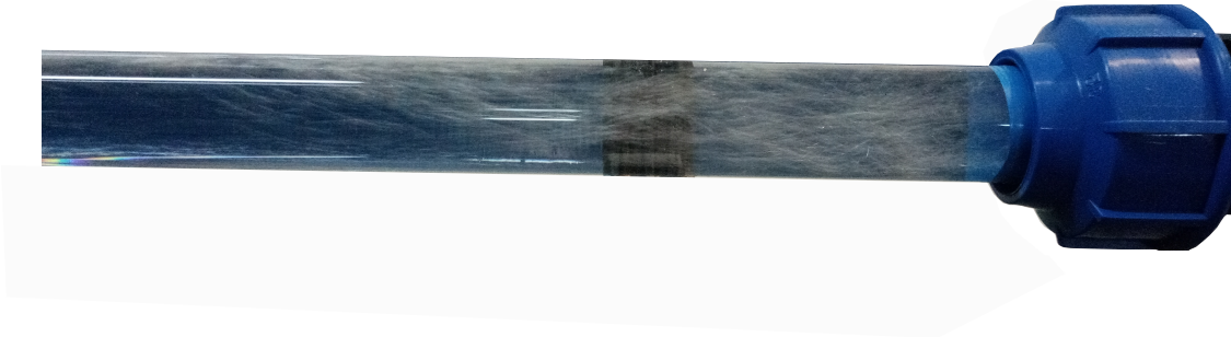
Слика 1.22. Приказ струјног поља непосредно иза вентила. Ради визуализације струјног поља, у воду су убачени мехурови ваздуха.
