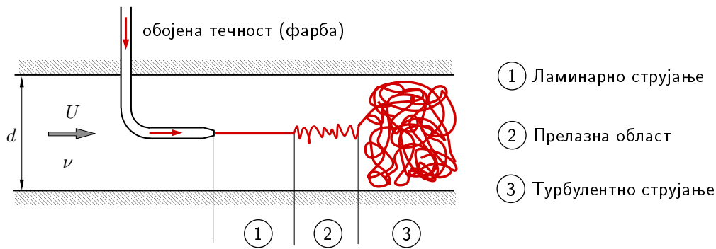
Слика 5.4. Рејнолдсов експеримент. Фарба се у облику струјног влакна из млазника убацује у флуид кинематичке вискозности \eta који струји средњом брзином U_s = 4\dot{V}/d^2\pi кроз цев пречника d . Запремински проток \dot{V} и други струјни и геометријски параметри су мењани у многобројним експериментима.
